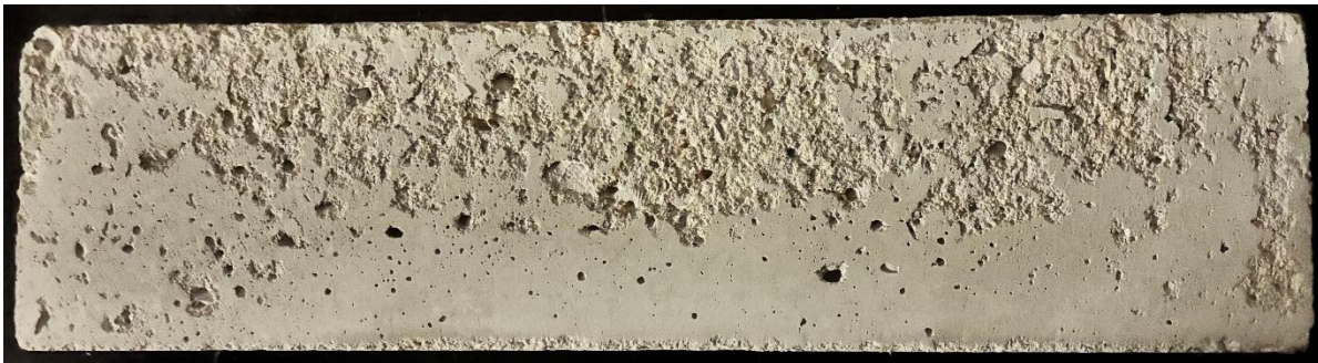
(d) Durability Factor: 84, Mixture ID = 0.45: S+WR 2
